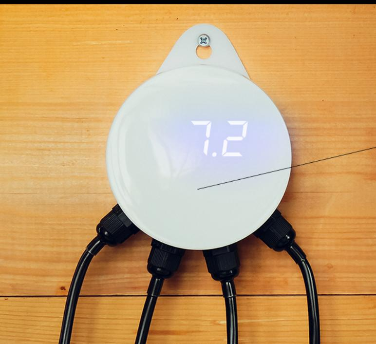
Прикрепите корпус весов к стенке улья, повесив его на саморез.
