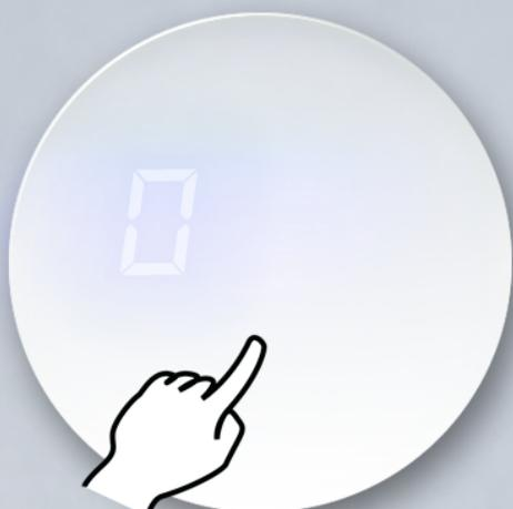
На дисплее отображается **0**. Убедитесь, что на датчиках нет нагрузки, и коснитесь сенсора один раз.
